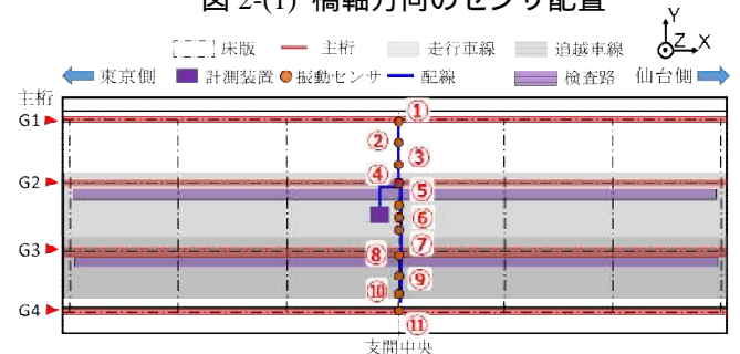
図2-(2) 橋軸直角方向のセンサ配置
