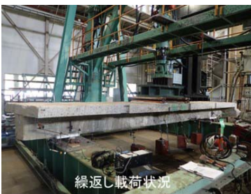
図-1 繰り返し載荷試験状況
