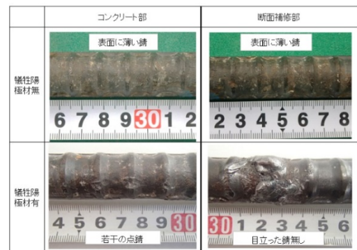
写真-1 試験後の界面付近の鉄筋の腐食状況
