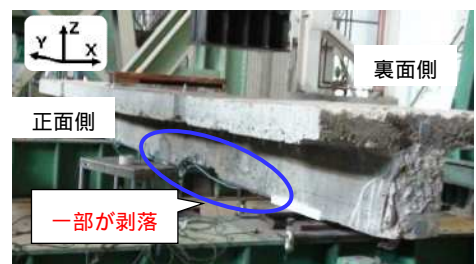
図3 載荷2000回後の試験体
