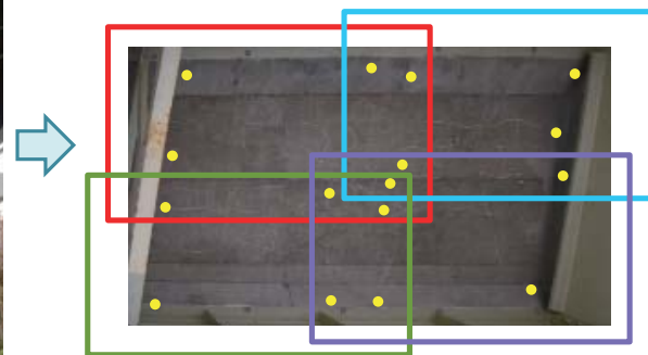
オーバーラップを確保した撮影
