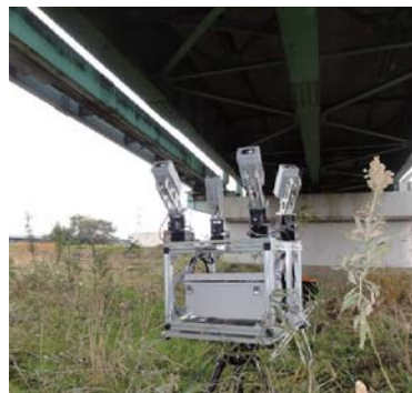
カメラと連動して標定点の3次元座標を取得
