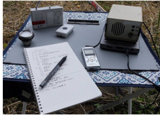
写真-4 簡易センサ感知器と記録状況
