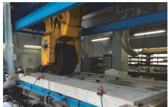
図-4 輪荷重走行試験状況
