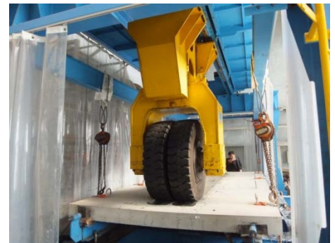
図1 輪荷重走行試験機
